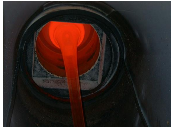
Abb. 2: Röhrenherstellung nach dem Vello-Verfahren. Quelle: obs/Osram GmbH
